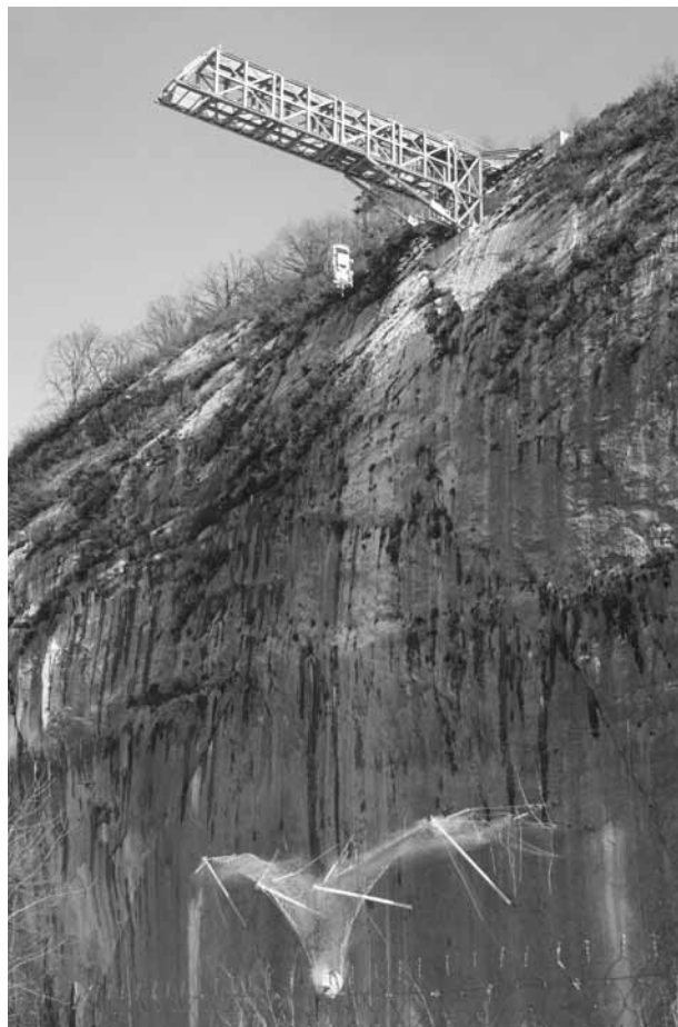
Photo 3. Le site aménagé : essai MEL 3000 kJ sur un écran ELITE® (cliché GTS).
