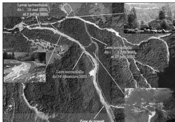
Figure 2. Localisation des écoulements de laves torrentielles de 2002 et 2003 sur le site de Nant des Pères (document RTM).
