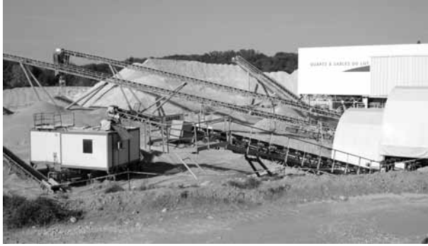
Photo 3. Usine de traitement, convoyeurs et stocks de produits finis (cliché Gérard Sustrac).
